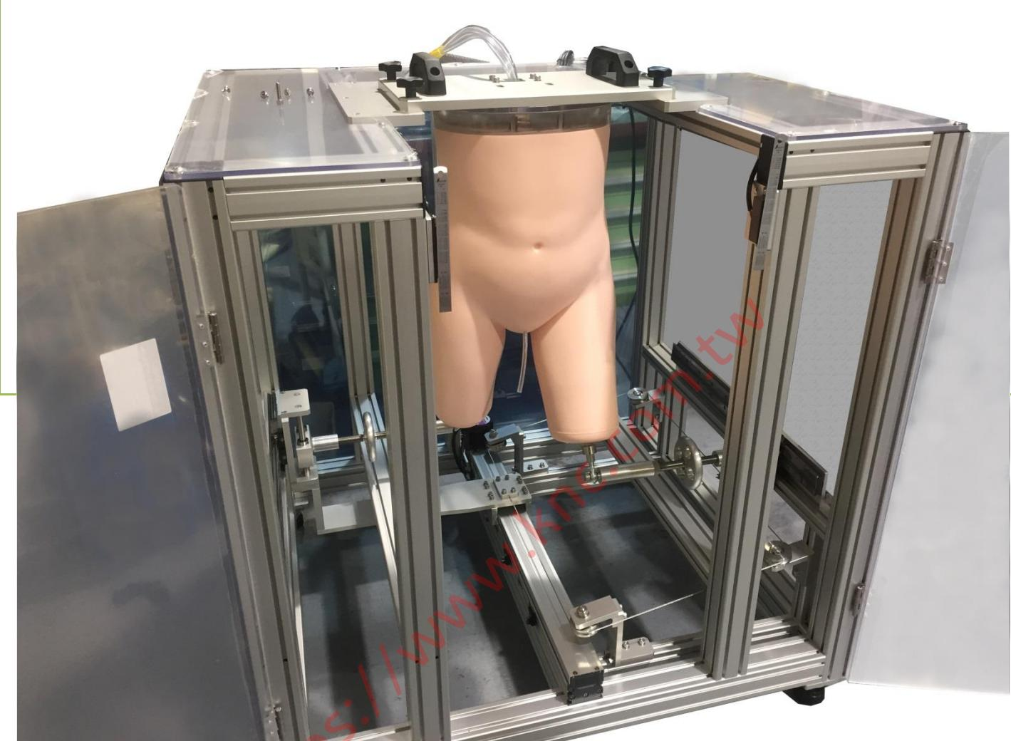
ダミー人形を取り付けて、実際に歩行している動作をさせた時の漏れ検証が可能。
